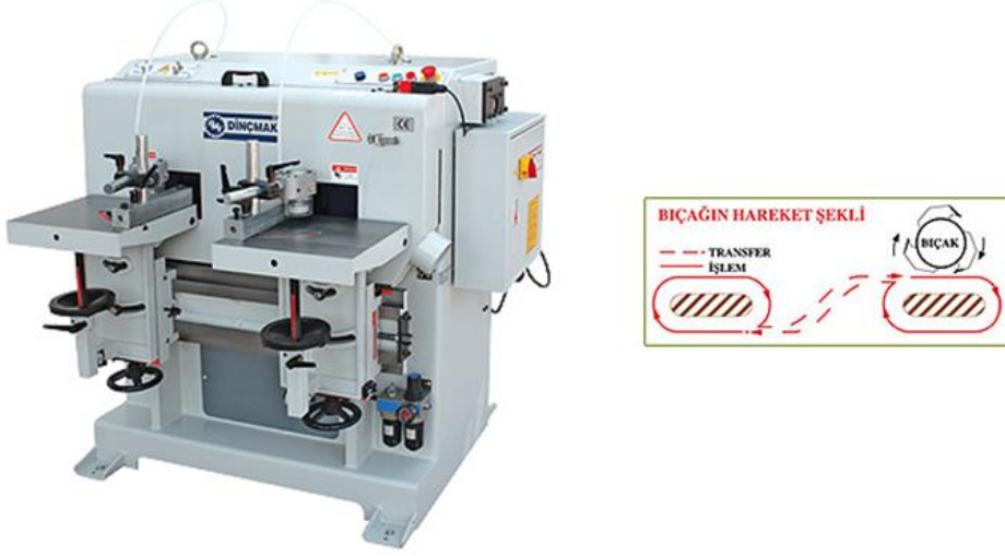
Resim 2. 1: Erkek zıvana makinesi genel görünüşü ve kesici hareket yönü
