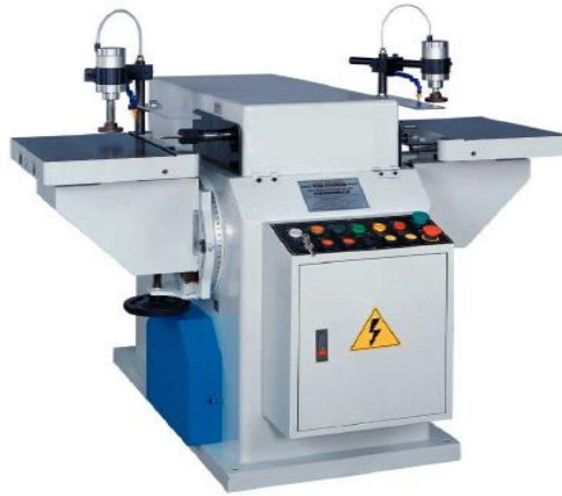
Resim 2. 8: Yatay diři zıvana makinesi genel görünüşü
