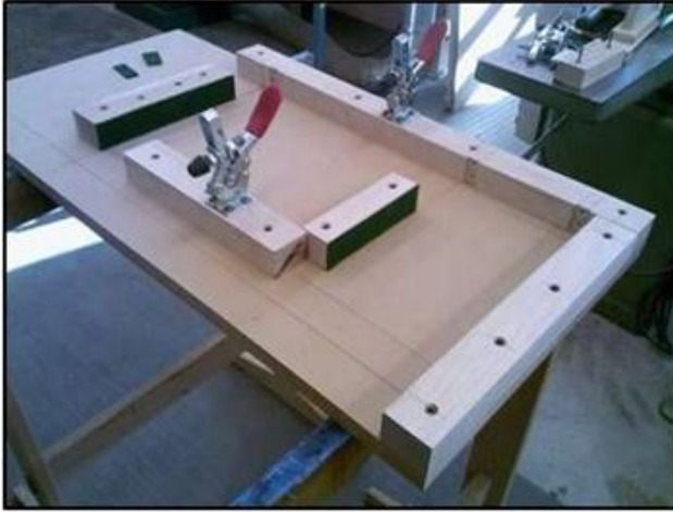
Resim 1.10: İş parçasını kalıba bağlamak için kullanılan sıkma düzeneği
