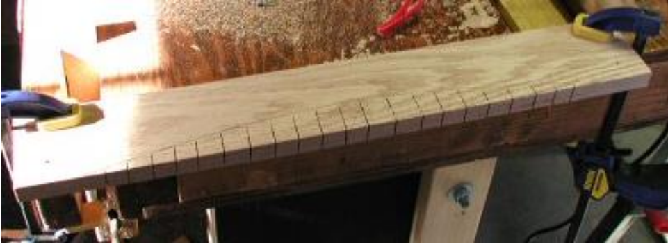
Resim 1.6: Kalıbın şekillendirilmeden önce çürütülmesi
